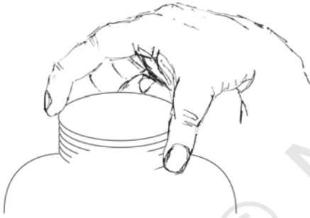
चित्र 7.21(a) ढक्कन को घुमाने के लिए हमारी उंगलियाँ उस पर एक बलयुग्म लगाती हैं
